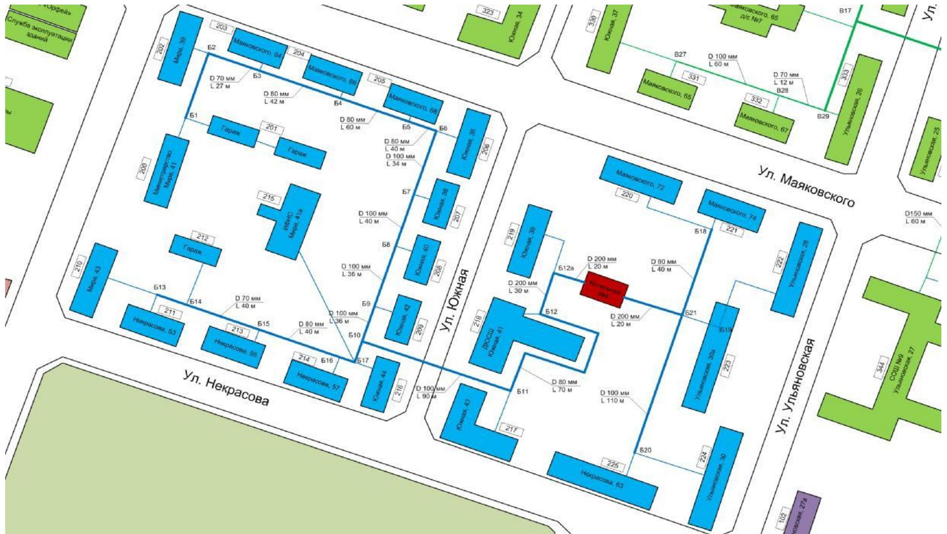
Рисунок 1.3.2.11 - Схема тепловых сетей котельной №16 г. Кинель
