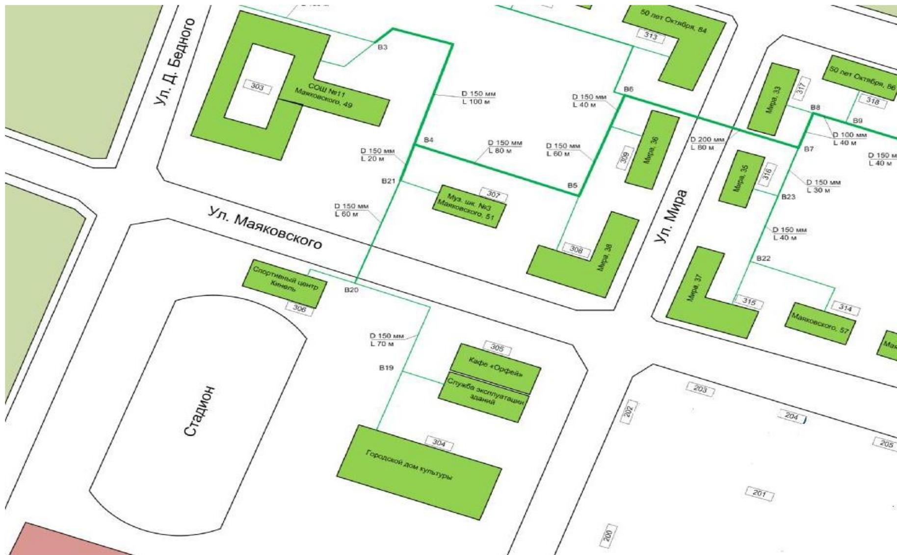
Рисунок 1.3.2.5 - Схема тепловых сетей котельной №3 г. Кинель
