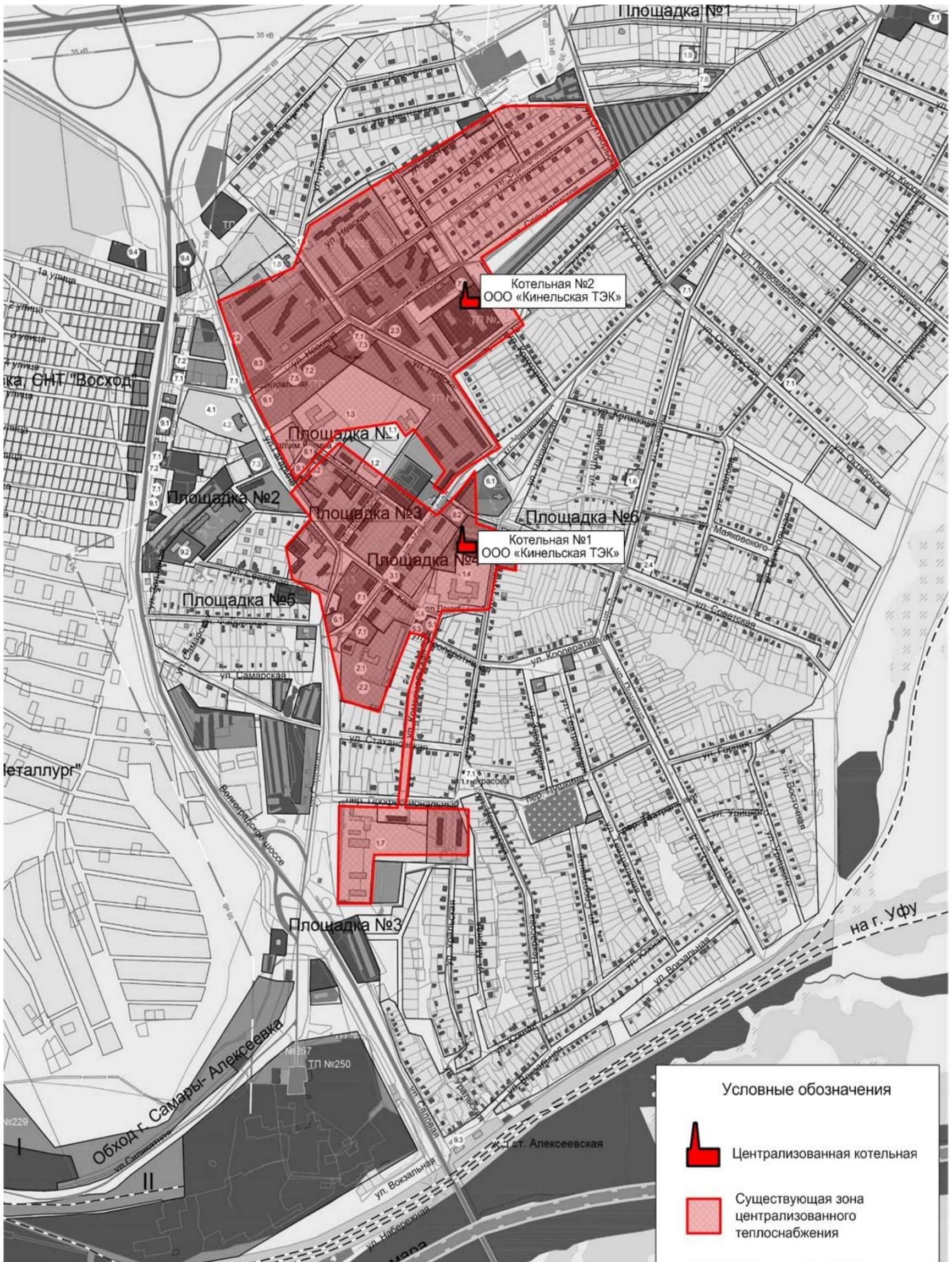
Рисунок 1.4.3 – Зоны действия существующей системы централизованного теплоснабжения п.г.т. Усть-Кинельский
