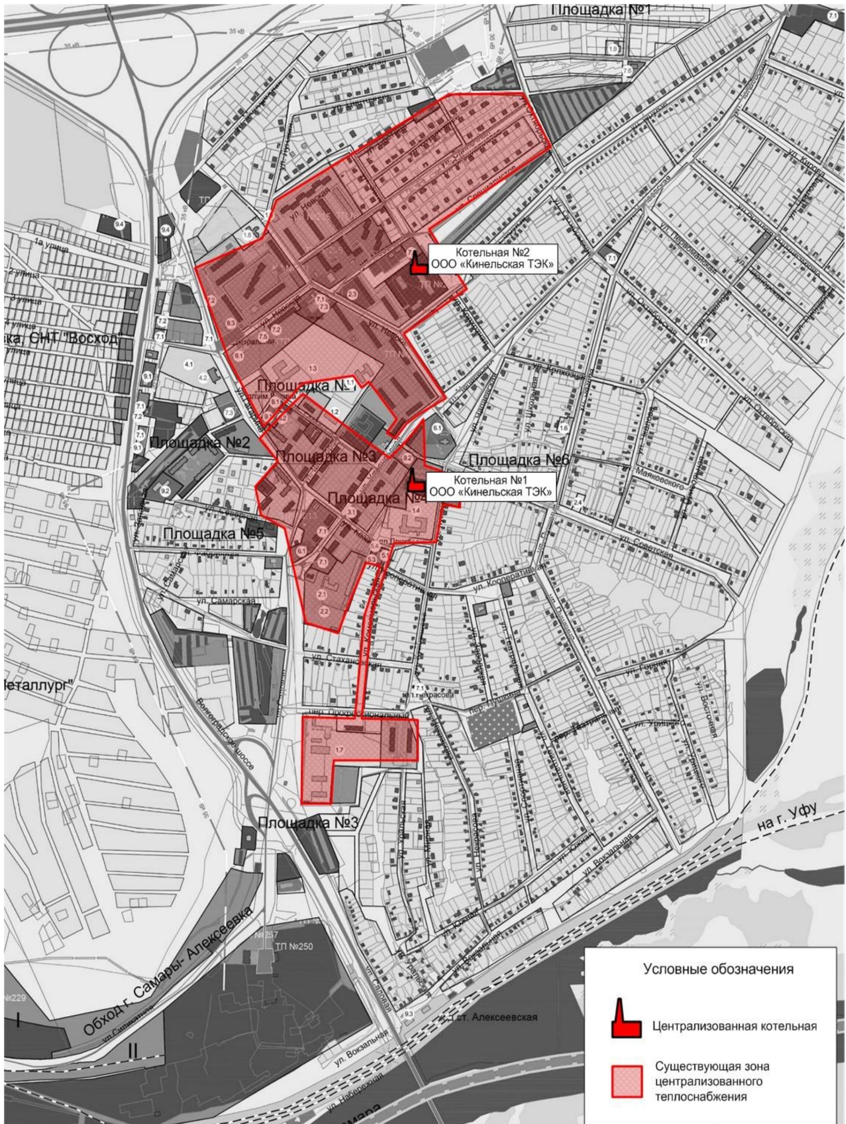
Рисунок 40 – Зоны действия существующей системы централизованного теплоснабжения п.г.т. Усть-Кинельский
