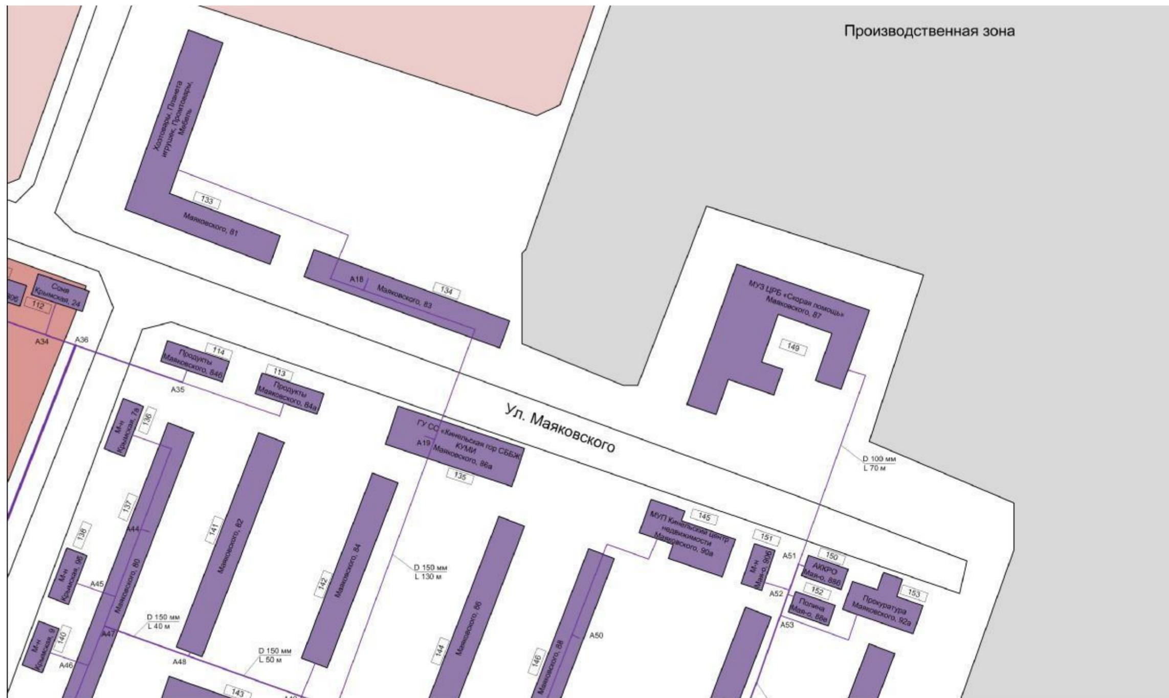
Рисунок 32 - Схема тепловых сетей котельной ВЧДР-8 г. Кинель
