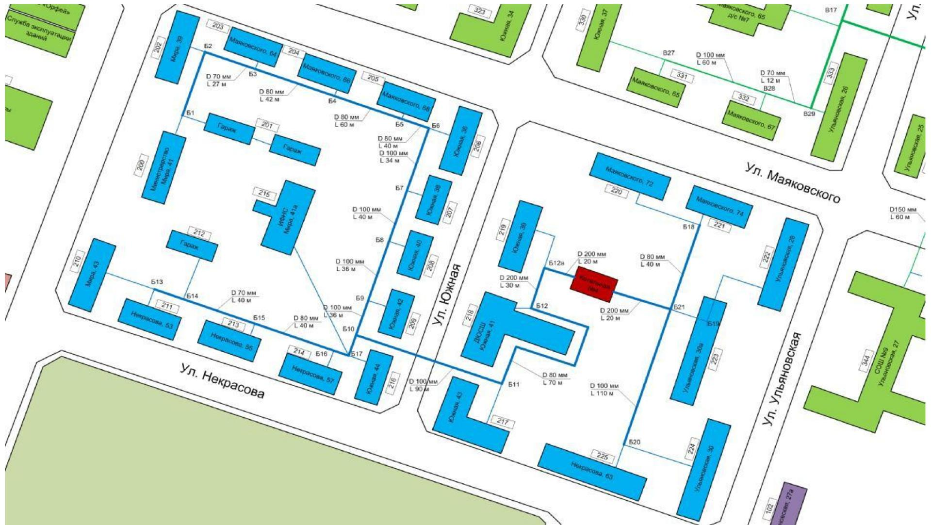
Рисунок 20 - Схема тепловых сетей котельной №4 г. Кинель
