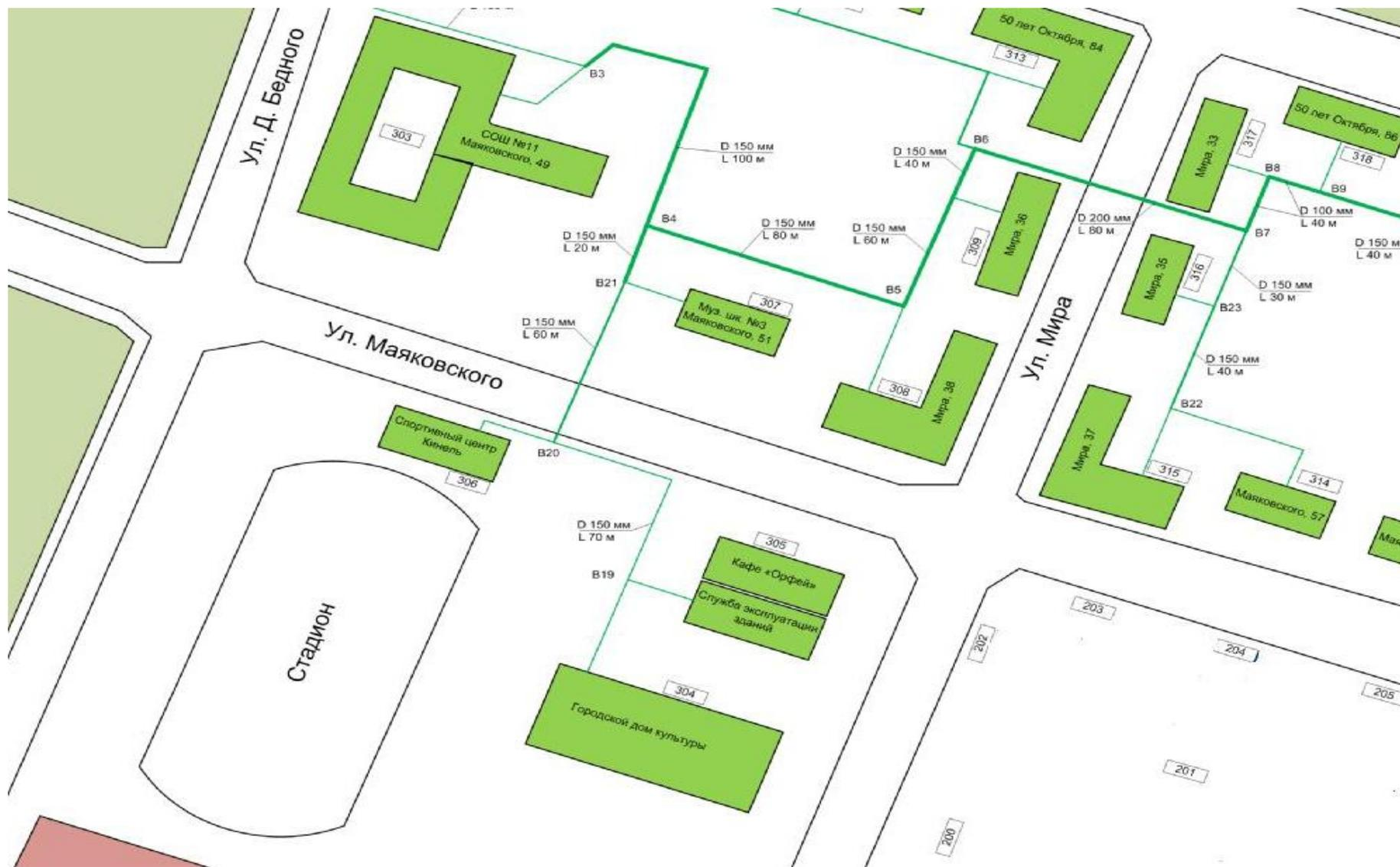
Рисунок 15 - Схема тепловых сетей котельной №3 г. Кинель
