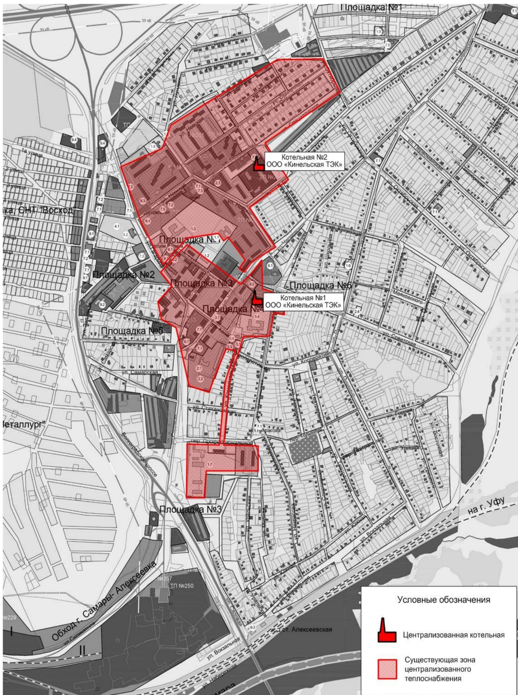
Рисунок 7 – Зона действия централизованной системы теплоснабжения п.г.т. Усть-Кинельский
