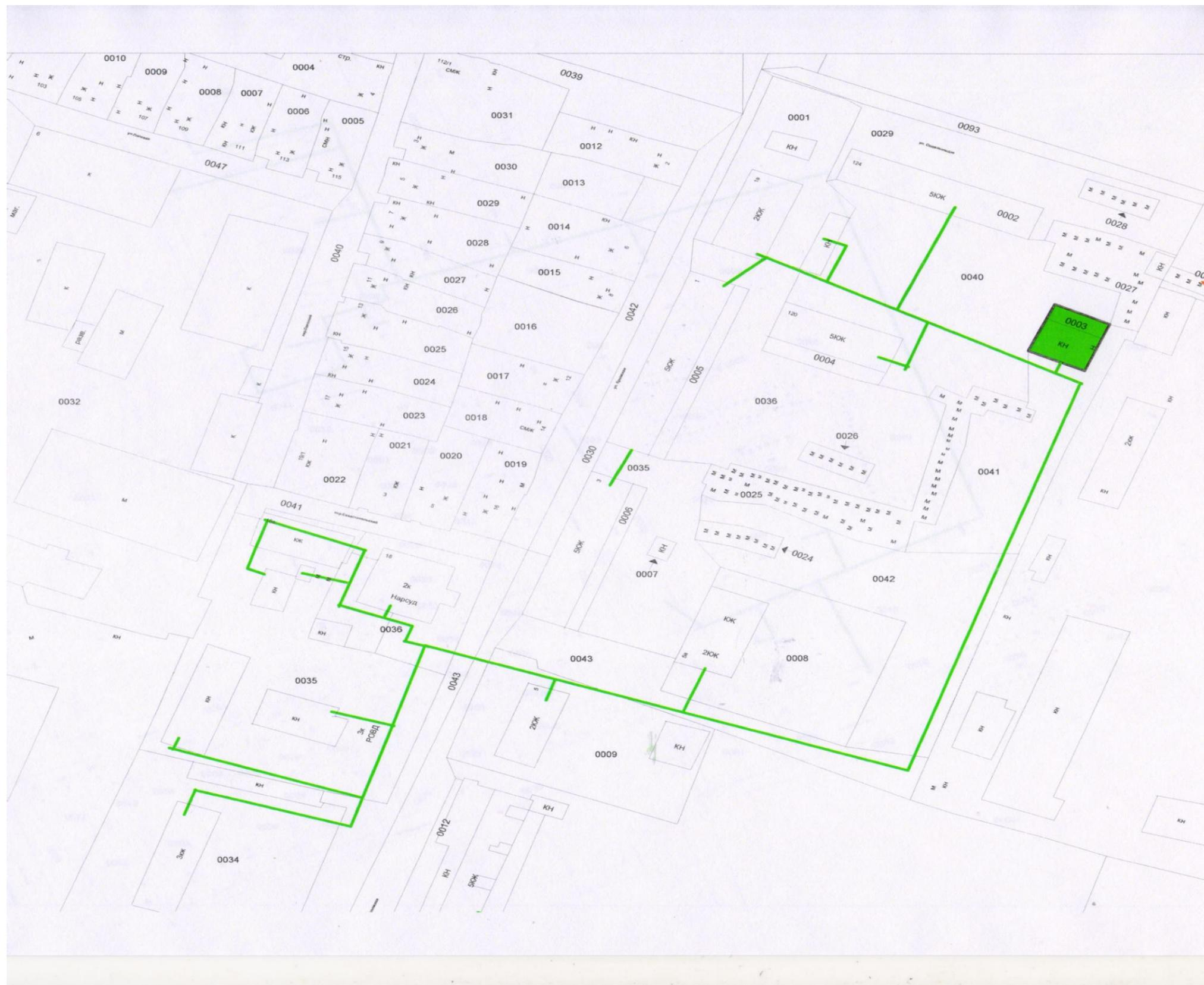
Рисунок 25 - Схема тепловых сетей котельной школы - интернат №9 г. Кинель
