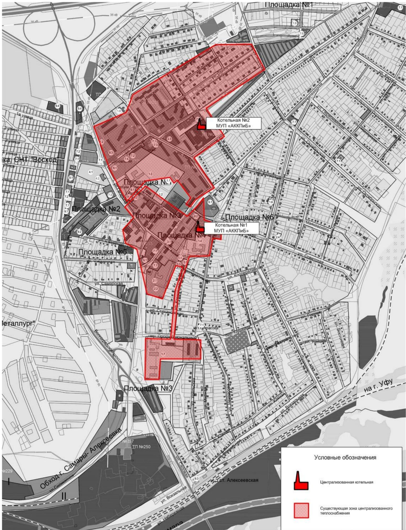
Рисунок 42 – Зоны действия существующей системы централизованного теплоснабжения п.г.т. Усть-Кинельский
