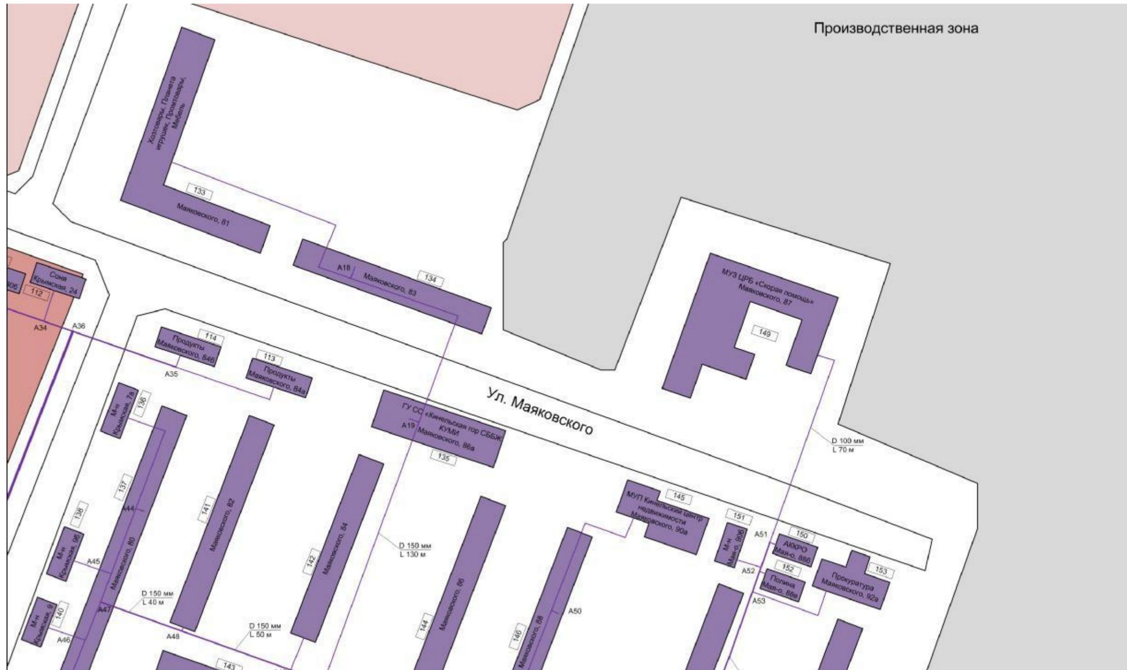
Рисунок 34 - Схема тепловых сетей котельной ВЧДР-8 г. Кинель
