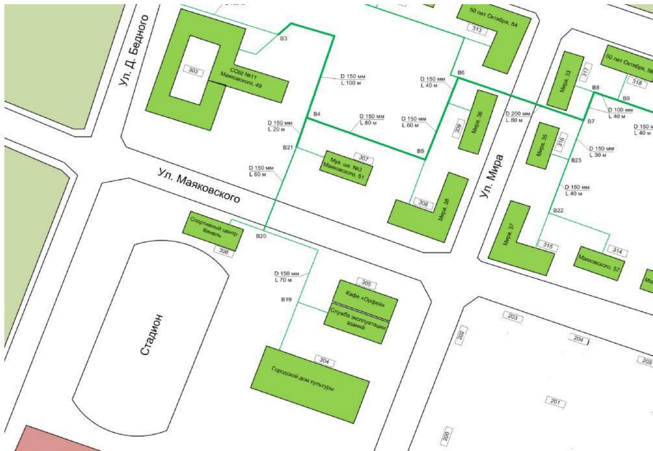
Рисунок 16 - Схема тепловых сетей котельной №3 г. Кинель
